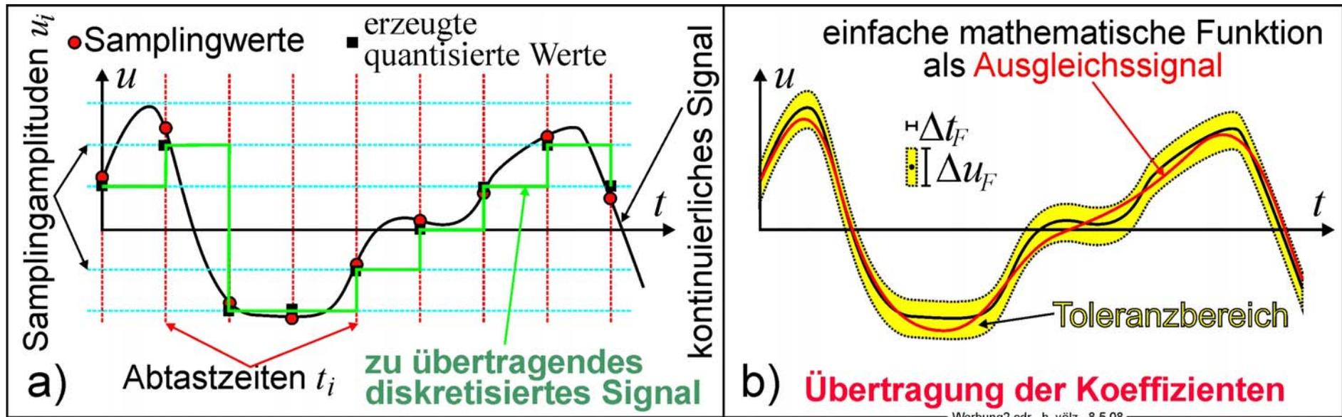
**Übliche Digitaltechnik** bildet Samples mit Takt  $\Delta t$  und festen Amplitudenstufen  $\Delta u$  es entstehen die o. g. Fehler und Sampling-Rauschen
