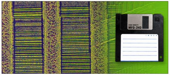
Abb. 4.: Untersuchung von magnetischen Strukturen auf Datenträgern (FDD).
